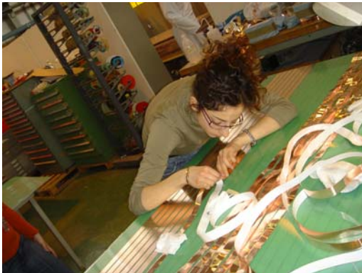
Una fase della costruzione dell'MRPC presso il CERN: realizzazione degli elettrodi di lettura (strip).
