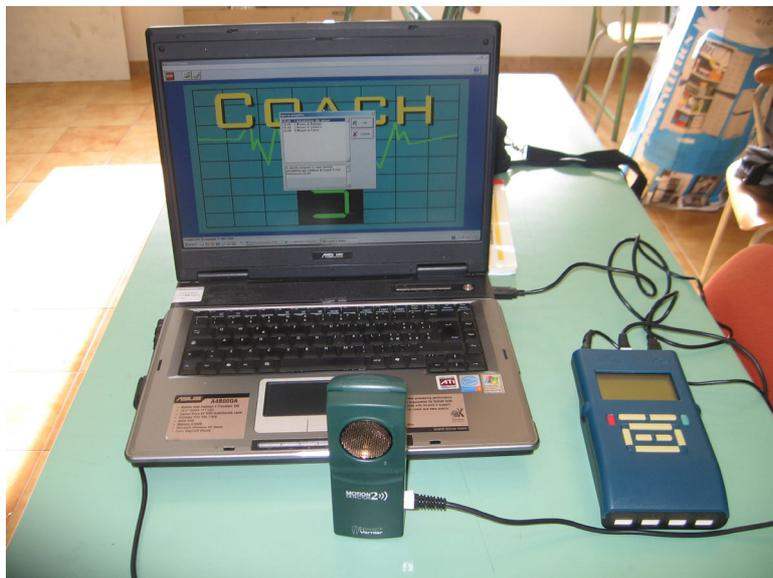
Il sensore di movimento si usa per misurare velocità, posizione e accelerazione di oggetti o persone in movimento. Il sensore si collega al PC tramite un'interfaccia analogico-digitale.
